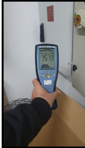
תמונה 3: הערך המתקבל בחזית לוח מונה סולארי
