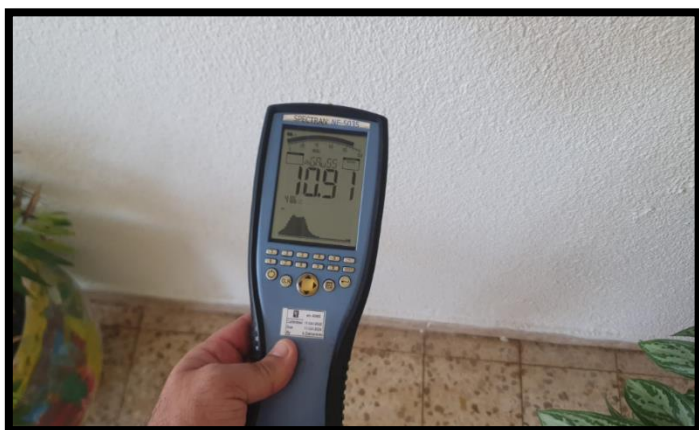
תמונה 5 הערך המתקבל במרחק 30 ס"מ מגב לוח החשמל מסדרון מעבר
