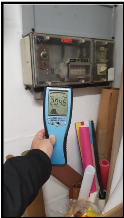
תמונה מס' 3: הערך המתקבל בחזית לוח חשמל ממיידי במרחק 20 ס"מ מהקייר
